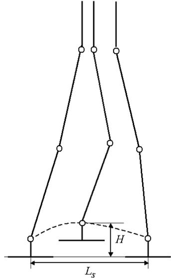
Fig. 3. Walking parameters.
